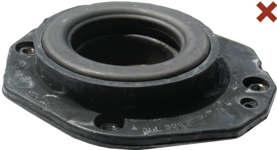
Fig. 1: Nieprawidłowo zamontowane łożysko oporowe amortyzatora teleskopowego
