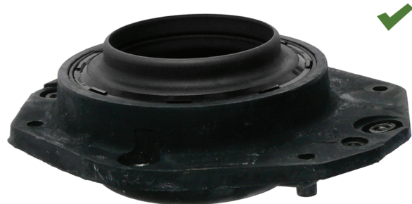
Fig. 2: Prawidłowo zamontowane łożysko oporowe amortyzatora teleskopowego
