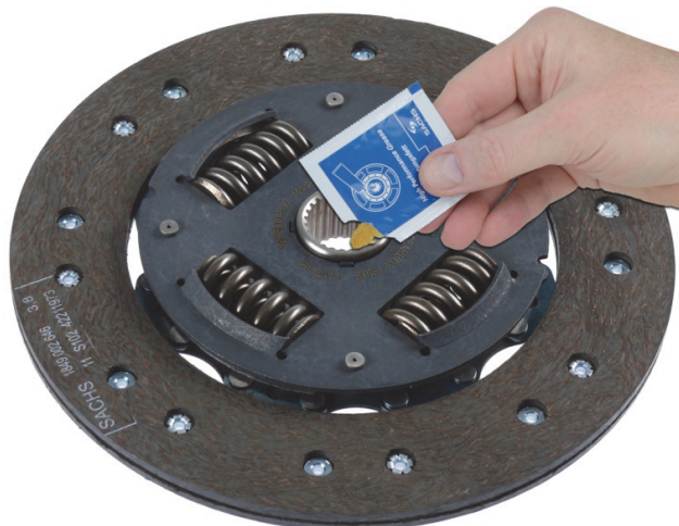
Rys. 1: Lekko nasmarować dookoła profil piasty tarczy sprzęgła
