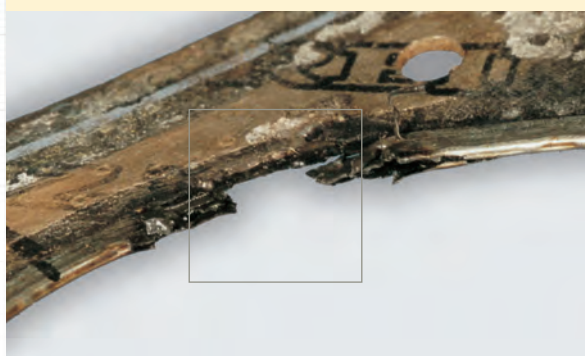
Wgniecenia i spłaszczenia z i bez nadmiernego nadmuchu na skutek pracy stukowej.
