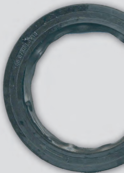
Uszkodzona krawędź uszczelniająca z PTFE jako przyczyna uszkodzenia.
