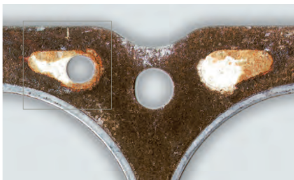
Napęcznienia miękkich uszczelnień głowicy cylindra na skutek przegrzania wraz z parowaniem.
