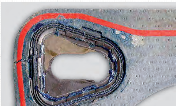
Pęknięcie lub wyrwanie materiału miękkiego i uszkodzony element Viton na skutek niewłaściwego nałożenia dodatkowych mas uszczelniających.
