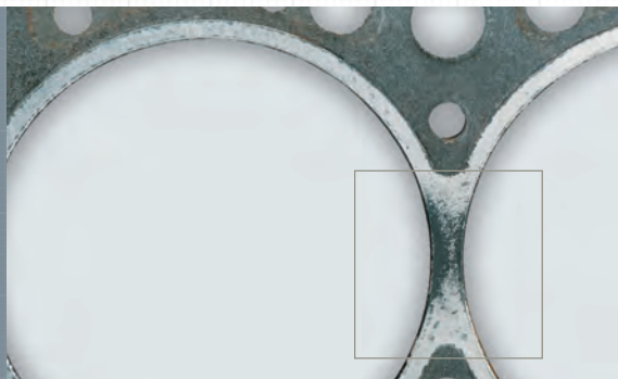
Wyciek gazu z mocnymi śladami powstałymi na skutek nadmiernego nadmuchu gorących gazów z komory spalania.
