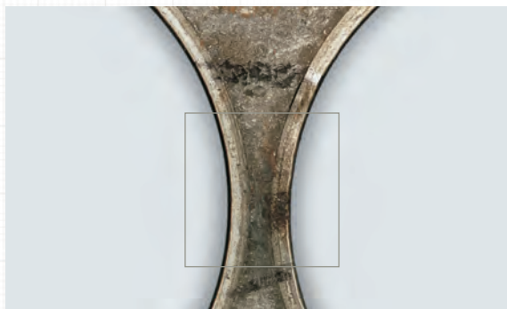
Wyciek gazu z miejscowym zaczerwienieniem opaski komory spalania.
