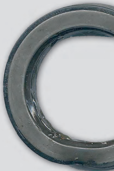
Natuszczona krawędź uszczelniająca z PTFE jako przyczyna uszkodzenia.
