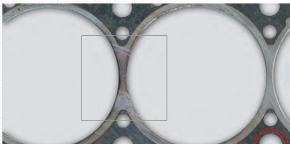
Porowate powierzchnie bloku silnika i głowicy cylindra powodują przemieszczanie się gazu pomiędzy komorami spalania.
