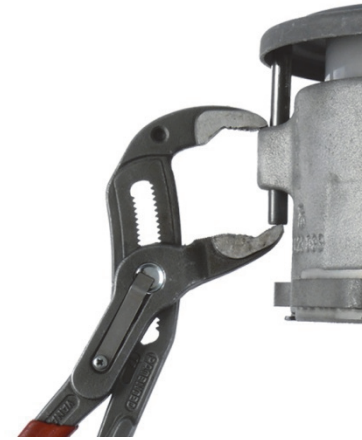
Rys.3: Ustawianie kołków karbowych
