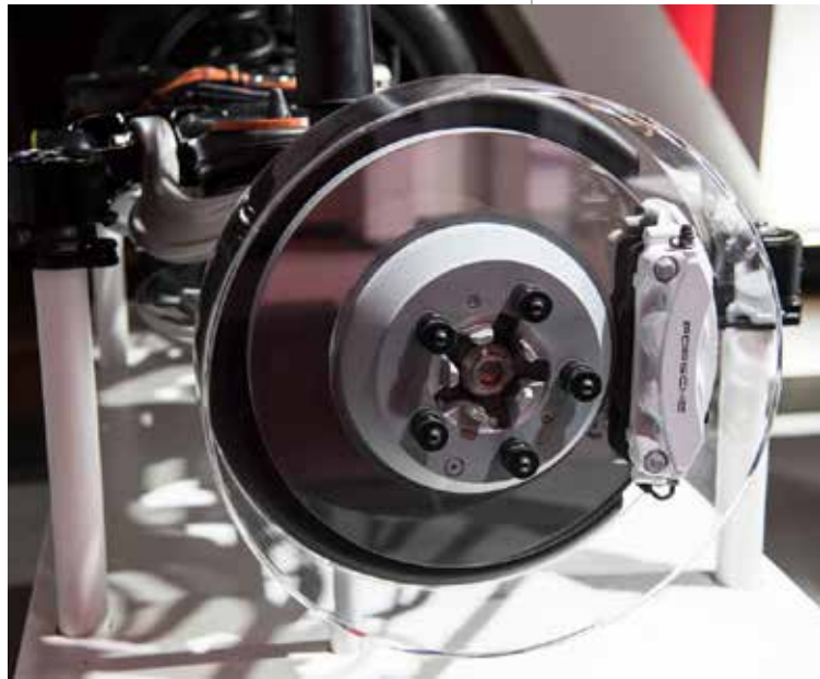
Tarcza hamulcowa iDisc oraz fragment układów zawieszenia i napędowego.
