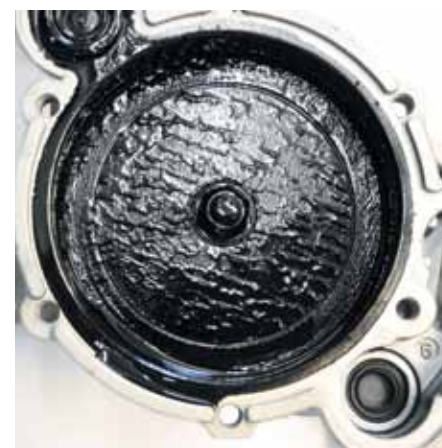
Rys. 3: Szlam olejowy w pompie próżniowej pojazdu VW Transporter wywołuje odgłosy stukania
